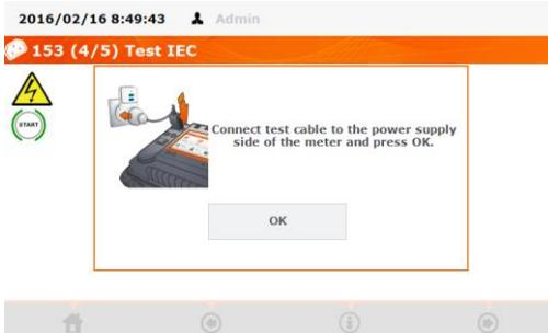
En caso de la corrección de conexiones, realizar siguiente comando que aparece. Conectar el dispositivo con el RCD al enchufe de red (en la pared) y conectar el cable de alimentación del PAT a la toma del dispositivo.
