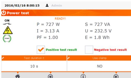
Después de la medición leer los resultados, comparándolos con las especificaciones del dispositivo examinado, se puede evaluar la corrección del resultado marcando la casilla correspondiente "**Resultado positivo**" o "**Resultado negativo**", en caso de guardar el resultado en la memoria, la evaluación también se guardará.
