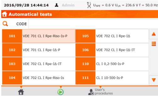
Después de seleccionar el método de medición (manual o mediante el escaneo del código del dispositivo), haga clic en el botón **(START)** en la pantalla.
